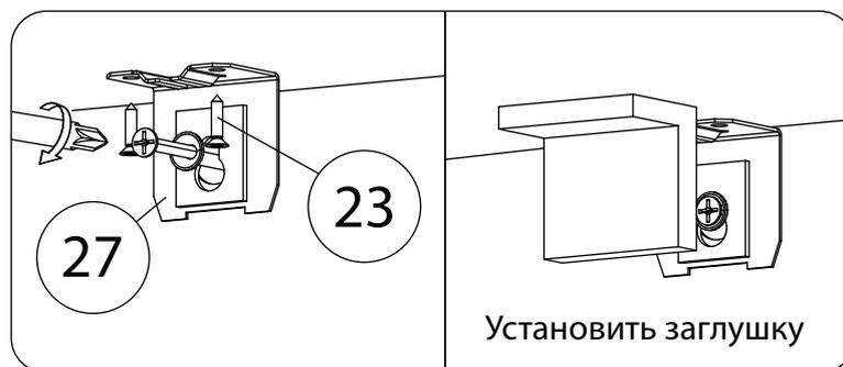
Опрокидывание мебели может привести к серьёзным телесным повреждениям. Рекомендуем зафиксировать изделие к стене при помощи мебельного навеса(27) для предотвращения его опрокидывания. Материалы стен различаются, поэтому крепежные средства не прилагаются. Используйте крепежные средства, подходящие для материала стен в Вашем доме. Для выбора крепежных средств обратитесь в специализированный магазин.
